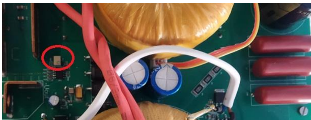
Рисунок 10 – Регулировочный резистор R66 на плате преобразователя
