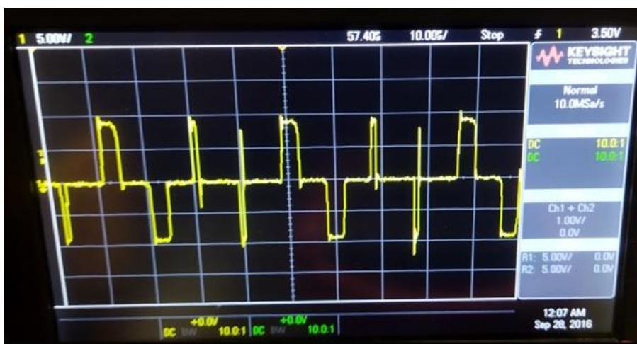
Рисунок 8 – Пример осциллограммы на выходе неисправного ЗУ
