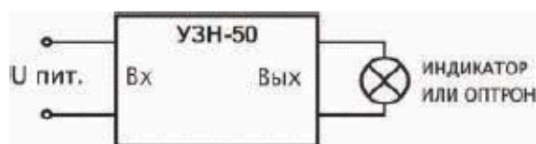
Рис. 24 Схема подключения (а) и внешний вид (б) устройства защиты от наводок 1
