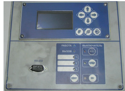
Рис. 25. Следы от продуктов горения на корпусе блока
