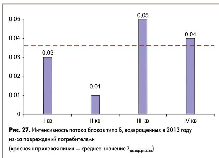
Рис. 27. Интенсивность потока блоков типа Б, возвращенных в 2013 году из-за повреждений потребителями (красная штриховая линия — среднее значение  $\lambda_{\text{возвр.рез.эо}}$ )
