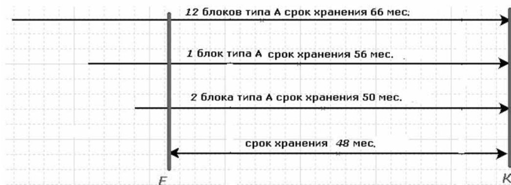
Рис. 3. Определение срока хранения блоков у потребителя
