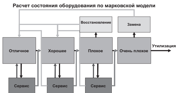
Рис. 2. Модель старения и состояния оборудования
